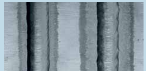
Lichtbogenstabilisierung durch VARIGON® S (links) im Vergleich zu Argon (rechts)
