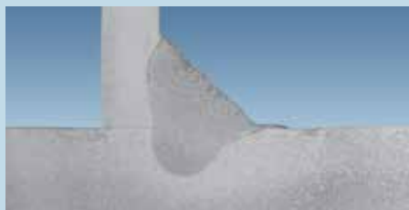
Richtungsstabilität des MIGp-Lichtbogens unter VARIGON® He30S vereinfacht „Dick-dünn-Verbindung“, hier 3 mm an 8 mm
