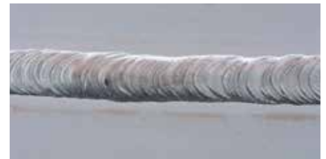
WIG-Naht, Wurzelseite formiert
