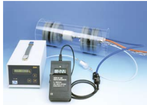
Messeinrichtungen zum Bestimmen des Restsauerstoffgehaltes, Bild: Jankus
