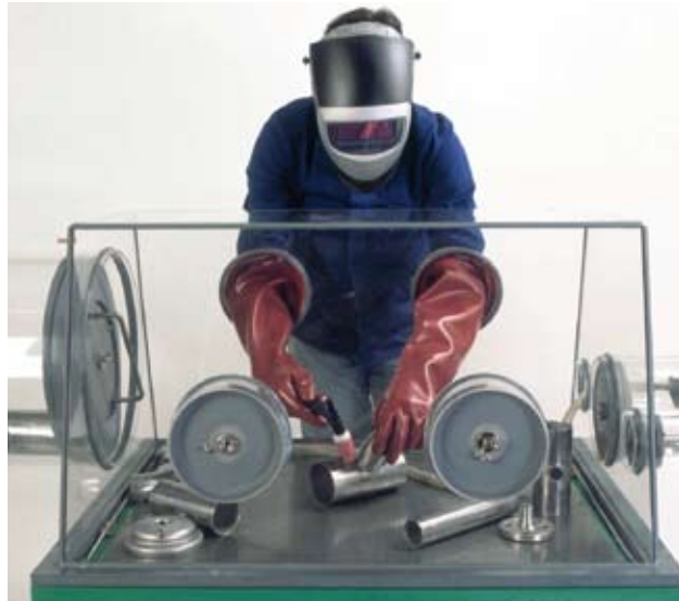
Kammer zum Schweißen in Inertgas-Atmosphäre, Bild: Jankus
