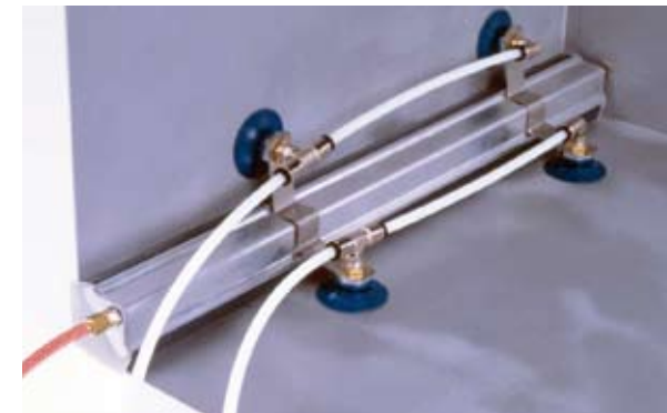
Formiereinrichtung für Kehlnähte, Bild: Jankus
