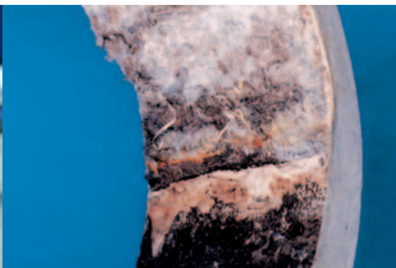
Kostspielig: Korrosionsschaden an einer Druckrohrleitung.
