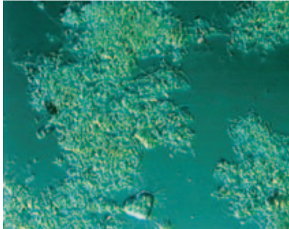
Kräftig ausgebildete Schlammflocke nach 14-tägiger Sauerstoffbegasung.
