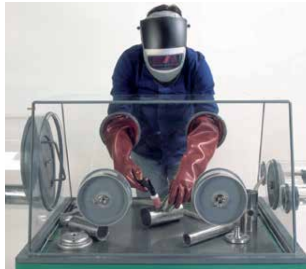
Kammer zum Schweißen in Inertgas-Atmosphäre, Bild: Jankus
